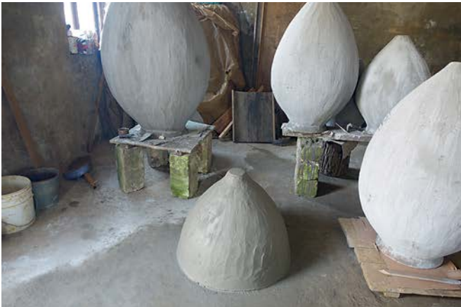
▣ Bild 1a und b: Die traditionellen georgischen Weinbereitungsgefäße „Qvevri“ werden aus Ton in Handarbeit hergestellt (links). Gebrannte Qvevris werden auf dem Kopf stehend gelagert, damit kein Schmutz eindringen kann (rechts) (Fotos: Georg Bätz)
