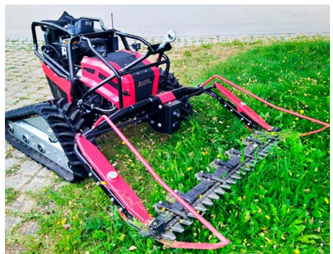
▣ Bild 3: Ferngesteuerter und autonom steuerbarer Raupen-Geräteträger mit höhenverstellbarem Mähbalken-Anbau bei einer der beiden Maschinenvorfürungen zum Thema „Mahd im öffentlichen Grün – effektiv und biodiversitätsschonend“ 2021
