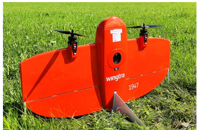
■ Bild 1: Das für das Projekt genutzte VTOL-System – eine WingtraOne (Foto: Daniel Scharvogel)
