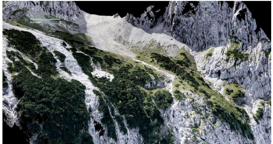
■ Bild 2: Eine colorierte 3D-Punktwolke ist ein Zwischenschritt bei der Berechnung von hochauflösenden Orthofotos aus Einzelbildern – hier ein Ausschnitt aus dem Oberreintal bei Garmisch-Partenkirchen (Foto: Andrej Oravec)
